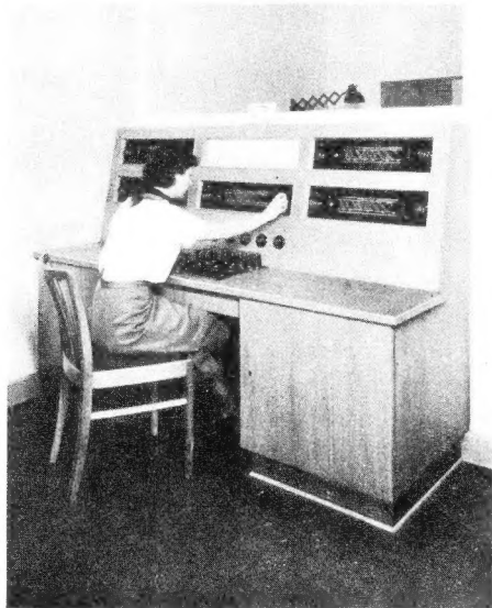
Bild 1. Zentralgesteuerte Rundfunkübertragungsanlage mit fünf Rundfunkempfängern und Zehnplattenspieler
